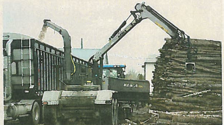
Les billes de bois passent dans la déchiqueteuse.
